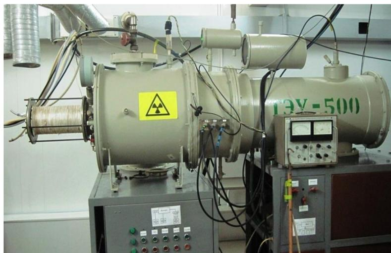
Рисунок 72 – Импульсный электронный ускоритель ТЭУ500
