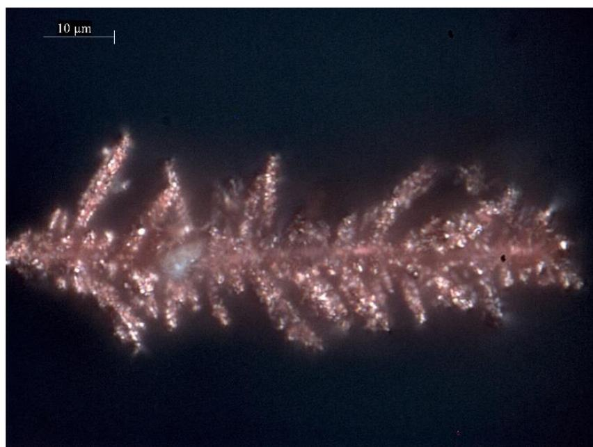
Рисунок 26 – Микрофотография порошка меди, полученного в ультразвуковой ванне с катодом, покрытой фильтровальной бумагой
